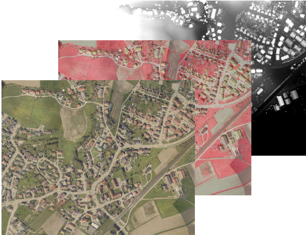
Abbildung 5.10: Eingangsdaten der Szene Ravensburg: VIS, IR und Laserscan.
