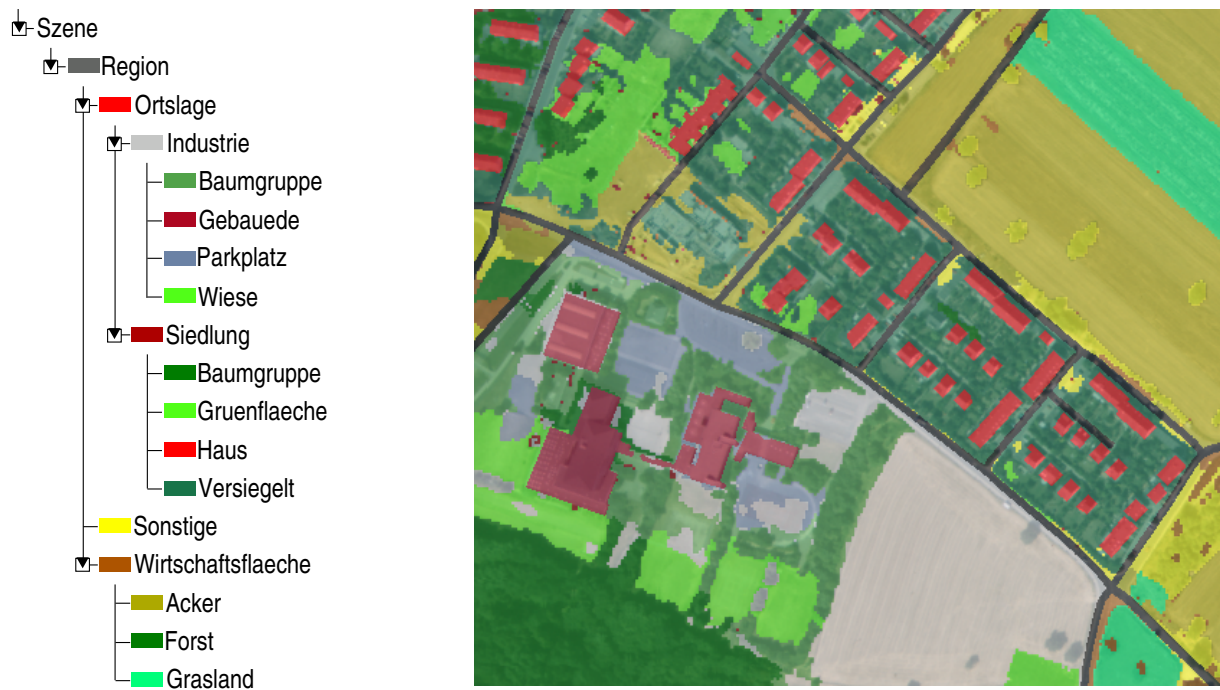
Abbildung 4.25: Interaktive Karte im Detailzustand mit durchgeblendetem visuellen Bild (rechts) und dazugehöriges semantisches Netz (links).
