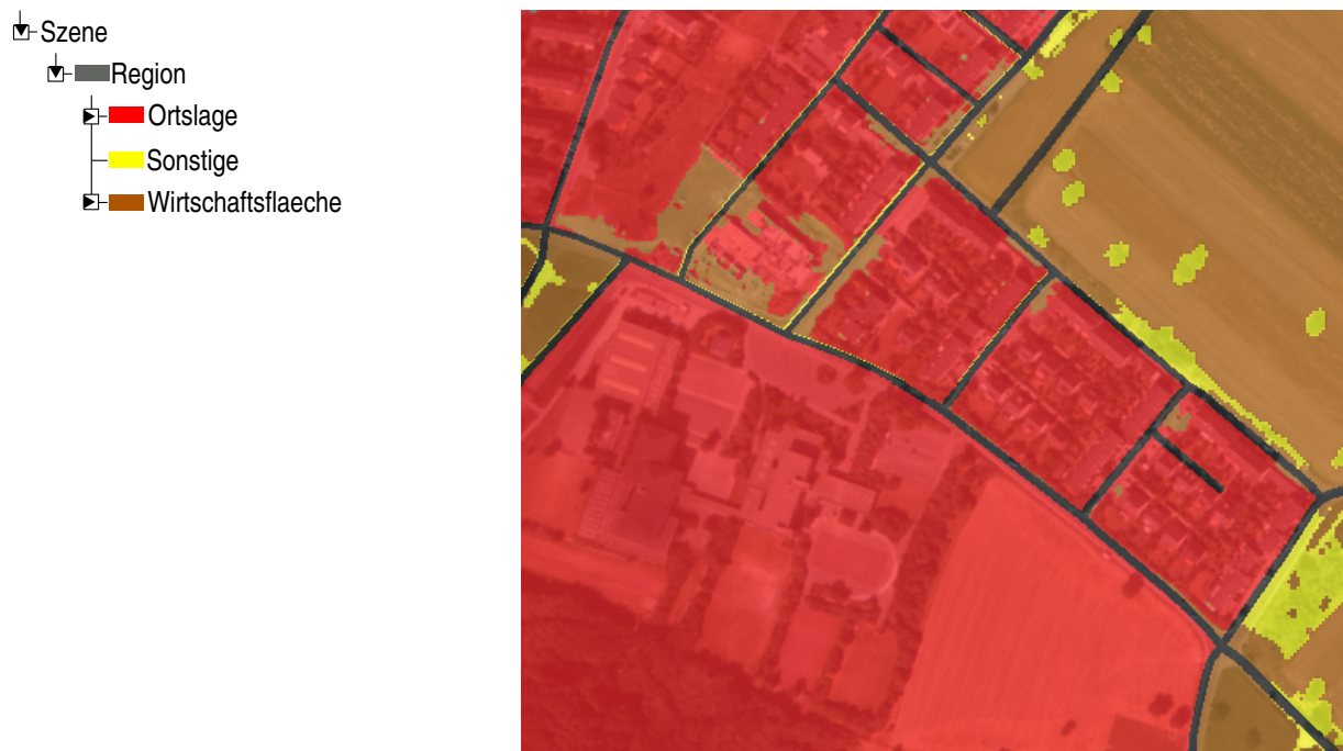
Abbildung 4.24: Interaktive Karte im Überblickszustand mit durchgeblendetem visuellen Bild (rechts) und dazugehöriges semantisches Netz (links).
