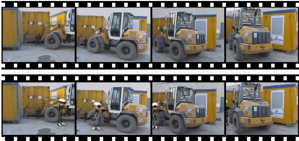
Bild 5 Originalsequenz (oben) und Sequenz mit eingefügtem, virtuellem Objekt (unten); entworfen mit dem Voodoo camera tracker und Blender.
